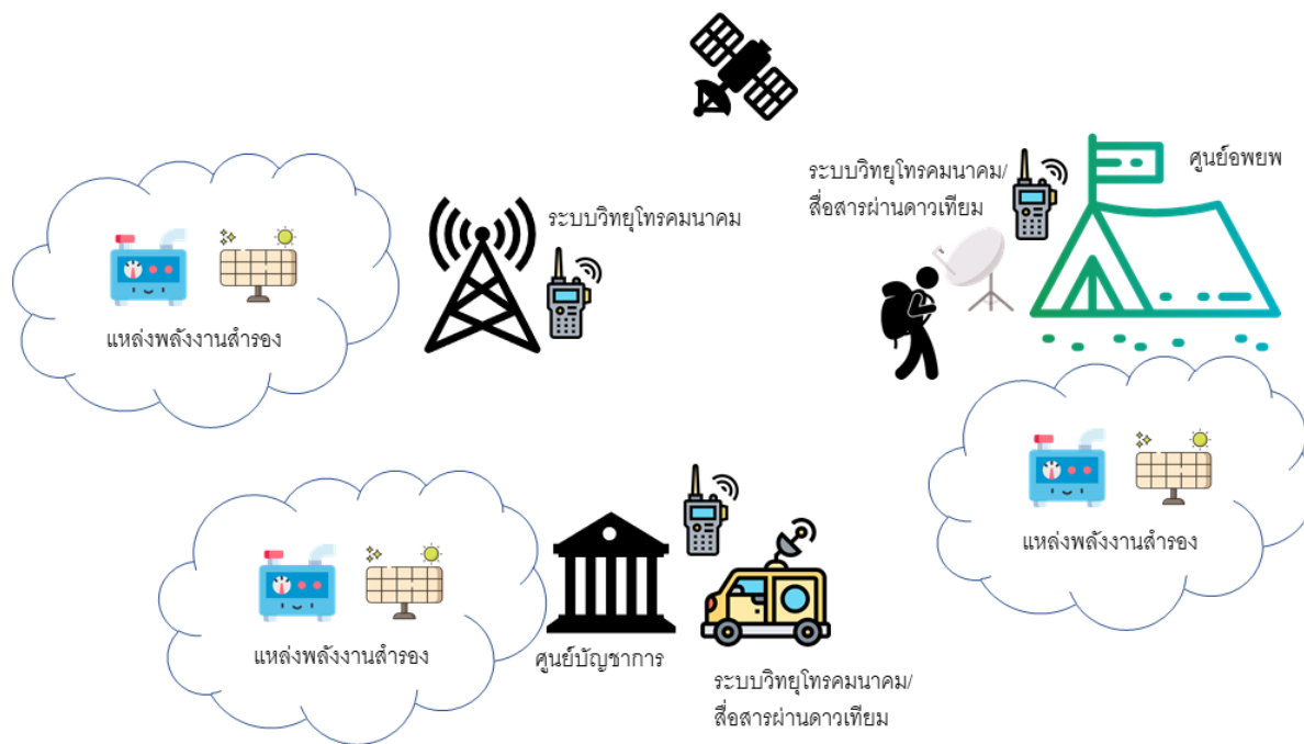
รูปภาพที่ ๕ ระบบสำรอง ระบบสื่อสารขัดข้องเนื่องจากเสาไฟฟ้าล้ม ไฟฟ้าดับเป็นเวลานาน สายไฟเบอร์ออฟติกขาด
